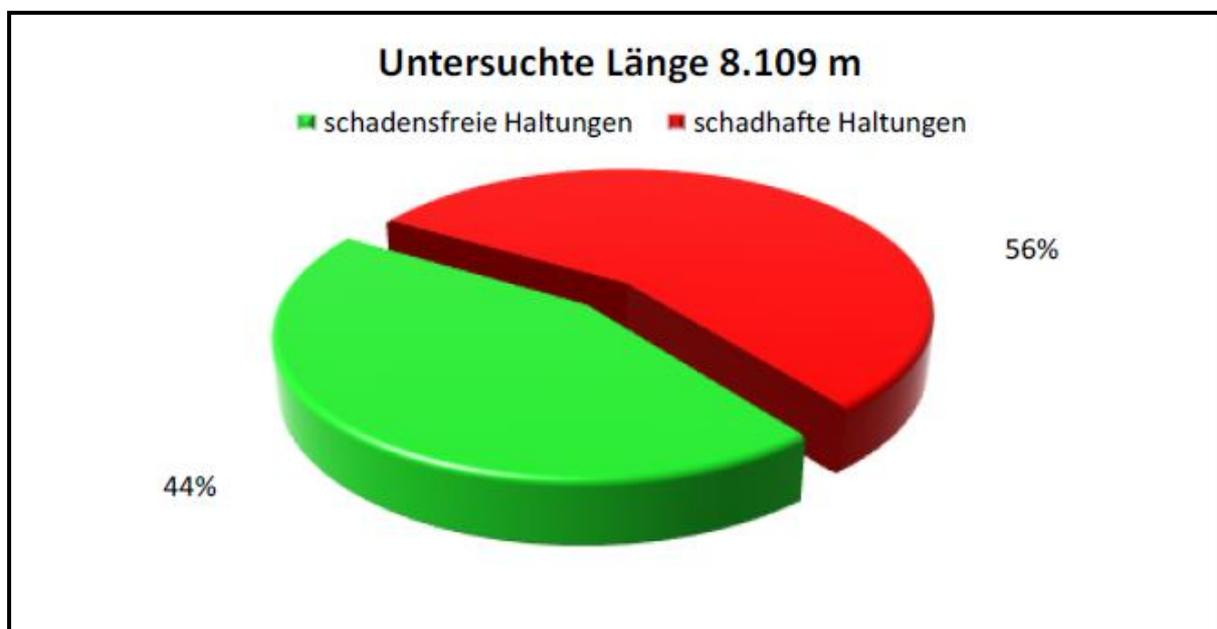
Ausschlaggebend für die schlechte Bewertung sind zudem Schäden wie Deformationen der Haltungen und Oberflächenschäden der Haltungen (Material Stahlbeton) die unter anderem der Zustandsklasse 3 zugeordnet worden sind.
